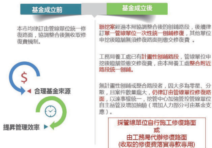
圖3.1 未來管線挖掘後路面修復模式
