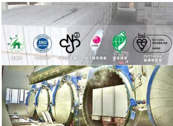
圖三 ALC產線（上圖為倉庫一隅、下圖為蒸壓釜蒸養過程）
